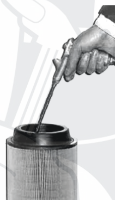
Рис. 6.3 Очистка фильтрующего элемента воздушного фильтра
