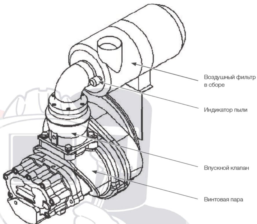
Рис. 4.3 Система воздухозабора
