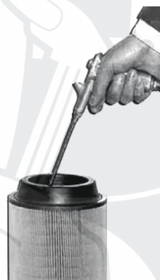
Рис. 11.3 Очистка фильтрующего элемента воздушного фильтра
